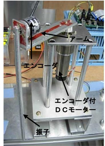
Fig.1 回転型倒立振子
