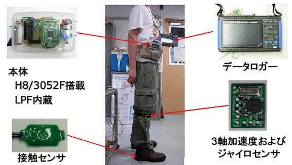
Fig. 1 実験システムと装着図
