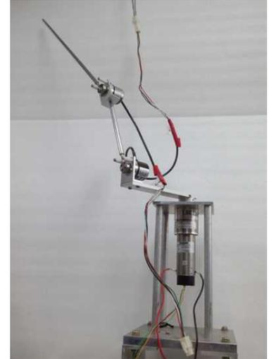
図 1 回転型 2 リンク倒立振子システム
