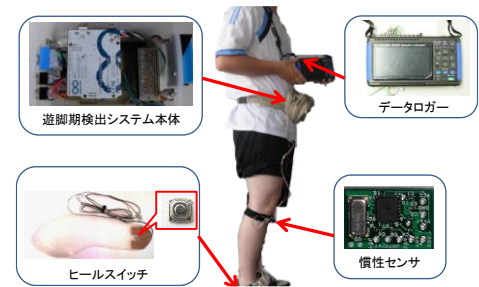
Fig.1 遊脚期検出システムの装着図
