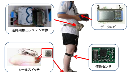
Fig.1 遊脚期検出システムの装着
