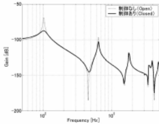
図 5 評価点  $Z_2$  の周波数応答 (ケース 2)
