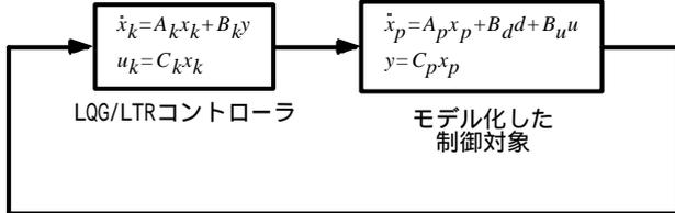
図2 制御システムのブロック線図
