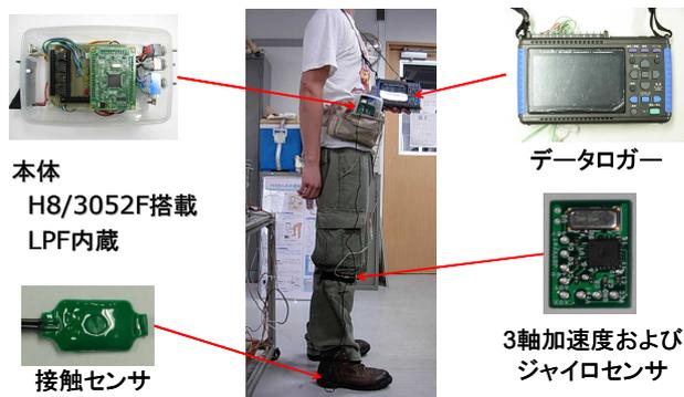
Fig.5 遊脚期検出システムと装着図
