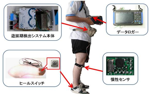
Fig. 2-3 遊脚期検出システムの装着図
