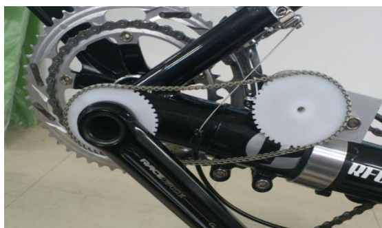
図 30 製作したスプロケットとラダーチェーン
