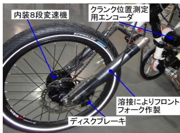
図 11 一号機 FES ユニットの詳細
