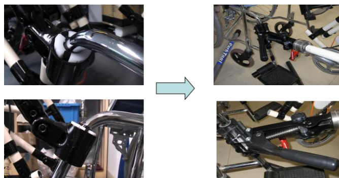
図 18 接続部分の簡易化
