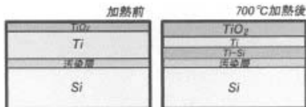
図17 未洗浄 Si/Ti 接触界面の 700°C 加熱前後のモデル
