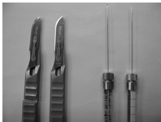
図12 TiO 2 コーティング後の手術用メス（左）と注射針（右）
