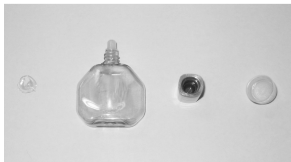
図10 TiO 2 コーティング後のコンタクトレンズと目薬容器およびキャップ
