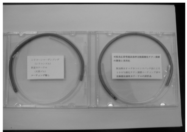
図 8 カテーテルへの \text{TiO}_2 コーティング前 (右) コーティング後 (左)
