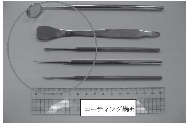
図5 歯科用器具への酸化チタンナノ薄膜のコーティング
