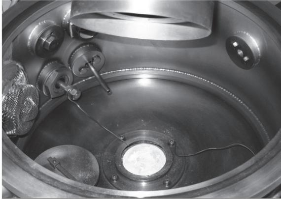
図13 スパッタ用真空チャンバー内部
