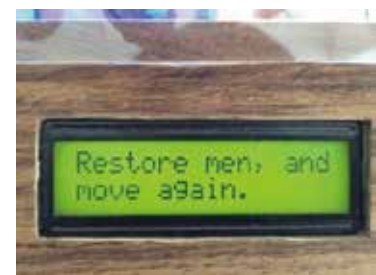
図 3.4 エラーが有る時の LCD の様子
