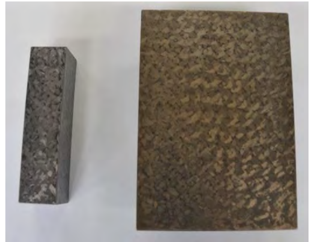
図1 実習製品(左)と摺り合わせ定盤(右)
