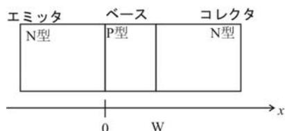
Fig.1 トランジスタの解析モデル
