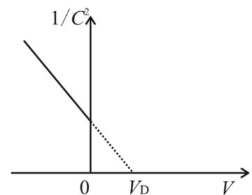
Fig.2 電圧-容量特性
