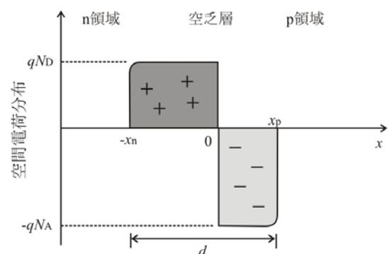
Fig.2 階段接合の電荷分布
