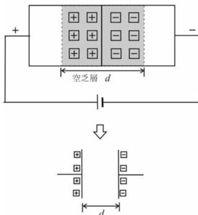
Fig.3 空乏層の静電容量
