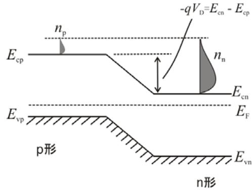
Fig.1 熱平衡状態の pn 接合
