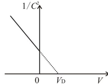
Fig.5 電圧-容量特性
