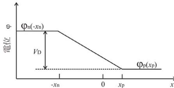
Fig.3 階段接合の電位
